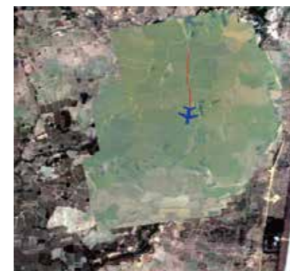
图4无人机影像与卫星影像匹配定位
